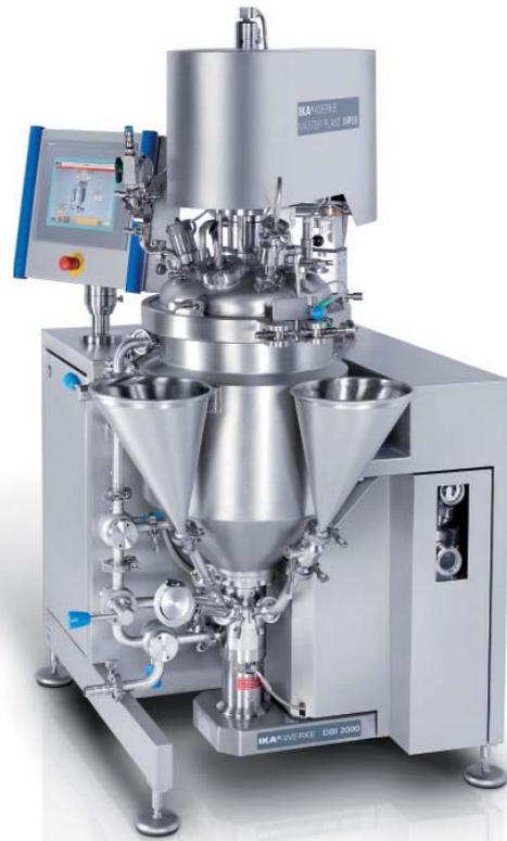
Système pilote Master Plant MP 50 avec deux entonnoirs d'alimentation séparés pour additifs liquides et solides
