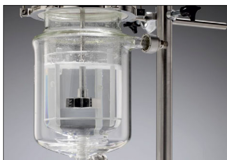
Agitateur de gazage BR à 0 t/min.
