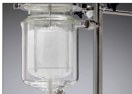
Agitateur de gazage BR à 1000 t/min.
