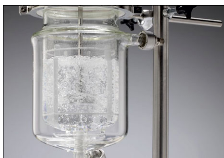
Agitateur de gazage BR à 500 t/min.
